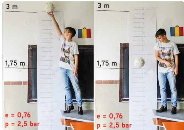
FIG. 5 Sujetar el balón a la altura h_1 (izquierda); soltar el balón (derecha)
