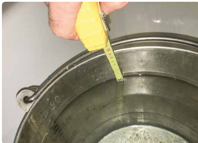
FIG. 2 Medir el nivel para obtener el volumen de agua
